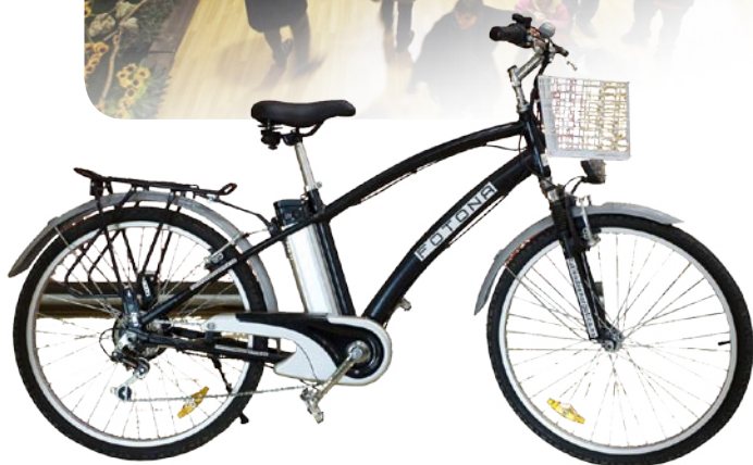
Bicicleta eléctrica. Motor 250W. Batería de Litio 36V 10Ah
